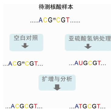
图 1 亚硫酸氢钠化学转化原理
